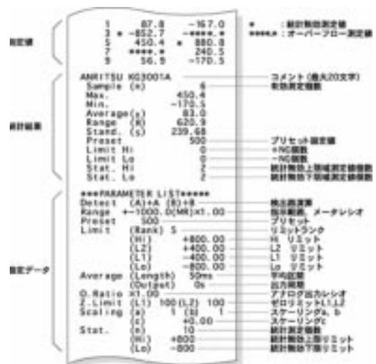
図8 統計結果の印字例
