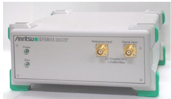
図1 SD5M01A 本体外観 External view of SD5M01A (231(W) × 108(H) × 300(D) mm, \leq 5 kg)
