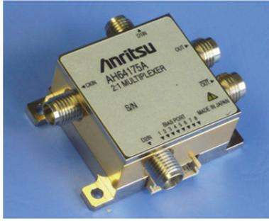
図 11 MUX モジュール写真
