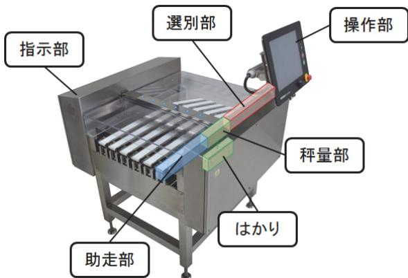
図2 SSVシリーズ複運用重量選別機のユニット構成
