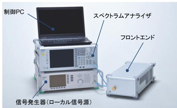
図3 190 GHz 帯スペクトラム測定システムの外観
