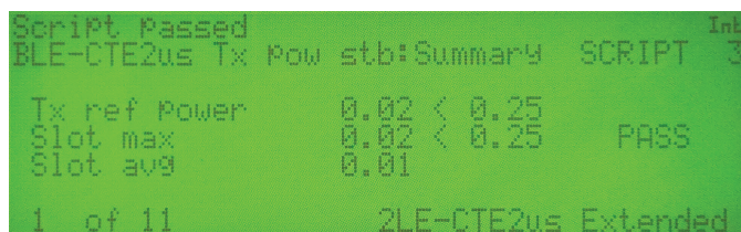
図 12 Tx Power Stability 測定画面 (Reference period, Slot 代表値)
