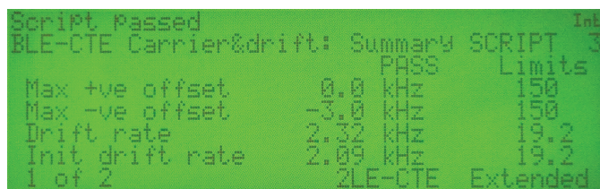
図 11 Carrier frequency offset and drift 測定画面
