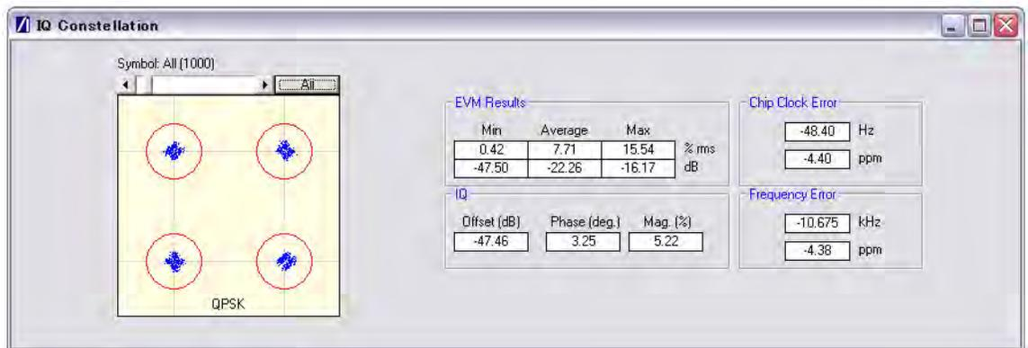
**Figure 11-26.** [IQ Constellation] Window showing DQPSK Constellation
