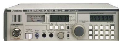
ML524シリーズ メジャリングレシーバ 周波数範囲：25 MHz～ 1000 MHz
