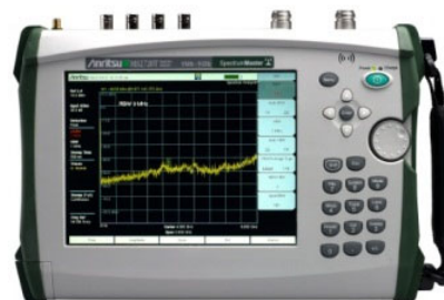
MS2720T-0709 周波数範囲：9 kHz～ 9 GHz 登録点検にも ご使用できます。
