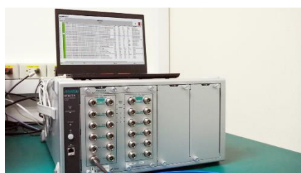
MT8870A通用無線測試儀支援5G Sub-6 GHz NR的RF測試以及其他各種同步無線通訊測試。
