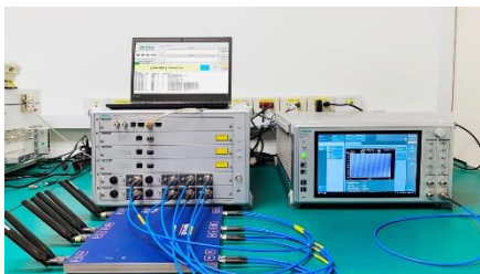
環鴻科技5G實驗室選用MT8000A搭配Azimuth ACC380以及MT8821C無線通訊綜合測試儀系列進行Sub-6 GHz NR頻段的RF量測與協定測試。
