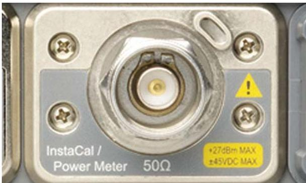
仪表上面板的内置高性能自动校准件InstaCal模块
