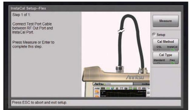
使用内置自动校准件InstaCal时的校准连接图和校准说明
