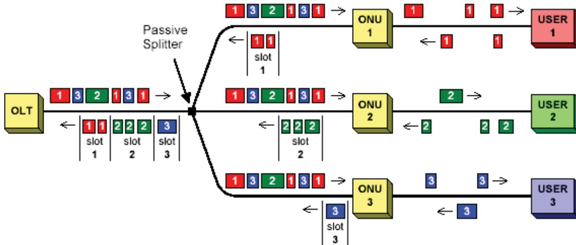
PON网络ONU到OLT使用的上行波长为1310nm，从OLT到ONU使用的下行波长为1490nm的波长（用于数据通信）和1550nm的波长（用于视频通信）。
