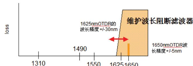
从上图可以看出，1625nm波长的OTDR有在1550的通信波长45nm的邻近位置出现的可能，不适合FTTH系统的滤波器管理；而1650nm波长的OTDR波长精度高，即使最短的波长也与1550nm的业务波长有着95nm的距离，因此非常适合FTTH维护使用，以及FTTH系统的滤波器管理。
