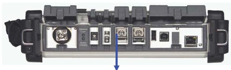
图2：1650nm波长在线测试的专用端口
