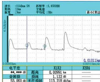
图3：MT9082的高分辨率性能保证用户即使是对于距离很近的事件都能获得更多的信息，从而完成快速的故障定位
