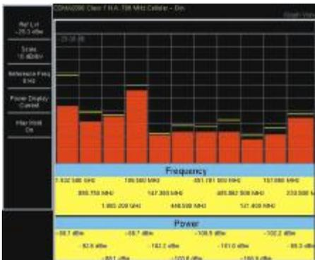
通过选件27, 信道扫描仪测量多个发射机的功率
