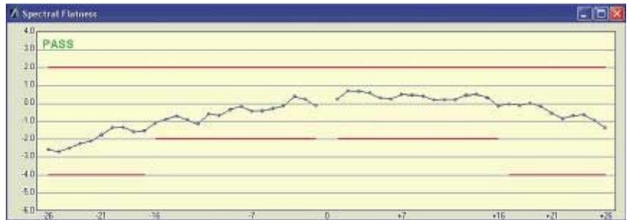
频谱平坦度测量要求测试仪表能捕获数据突发的8us信道估计时间。仪表测量每个子载波的功率并且显示为相对的功率曲线。IEEE802.11-2007规定，+16~-16的子载波(不包括0号子载波)相对于这32个子载波的平均功率的偏差不应大于±2 dB。±17~±26子载波相对于中间的32个子载波的平均功率的偏差不应大于+2dB ~ -4 dB。这项测试保证了其他的WLAN接收机有足够的余量来接并解调由这个发射机发射的数据包。MT8860C直接以图形方式显示频谱平坦度的测量结果。
