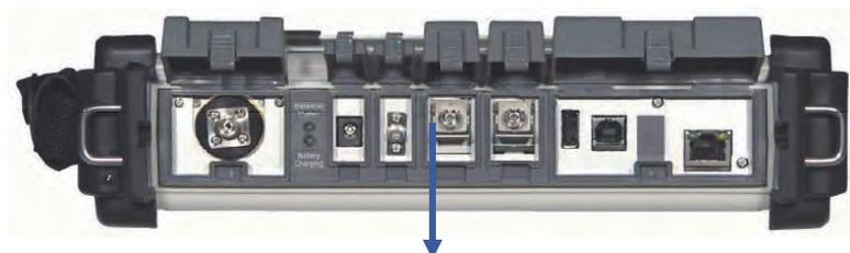
图2：1650nm波长在线测试的专用端口
