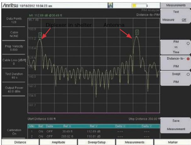
无源互调故障定位 (DTP) PIM 大小 (dBm) vs. 距离 (米)
