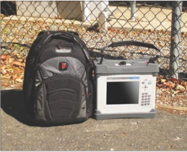
PIM Master MW82119A 2 x 40瓦射频输出，电池供电
