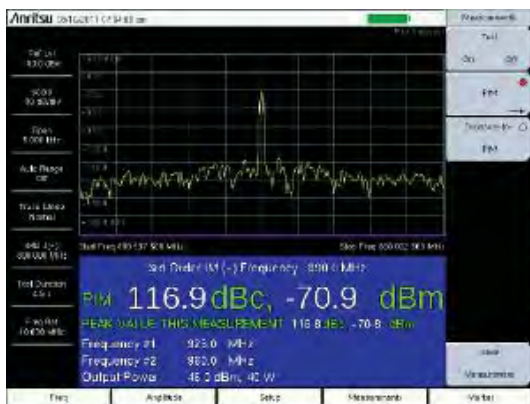
40瓦90MHz残留无源互调测试曲线图 曲线瞬时值显示或最大保持 无源互调测试值下有峰值显示
