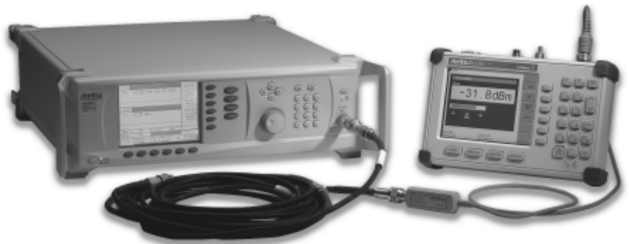
使用功率监控器在带有或不带有一个外部合成器的情况下进行绝对功率测量。
