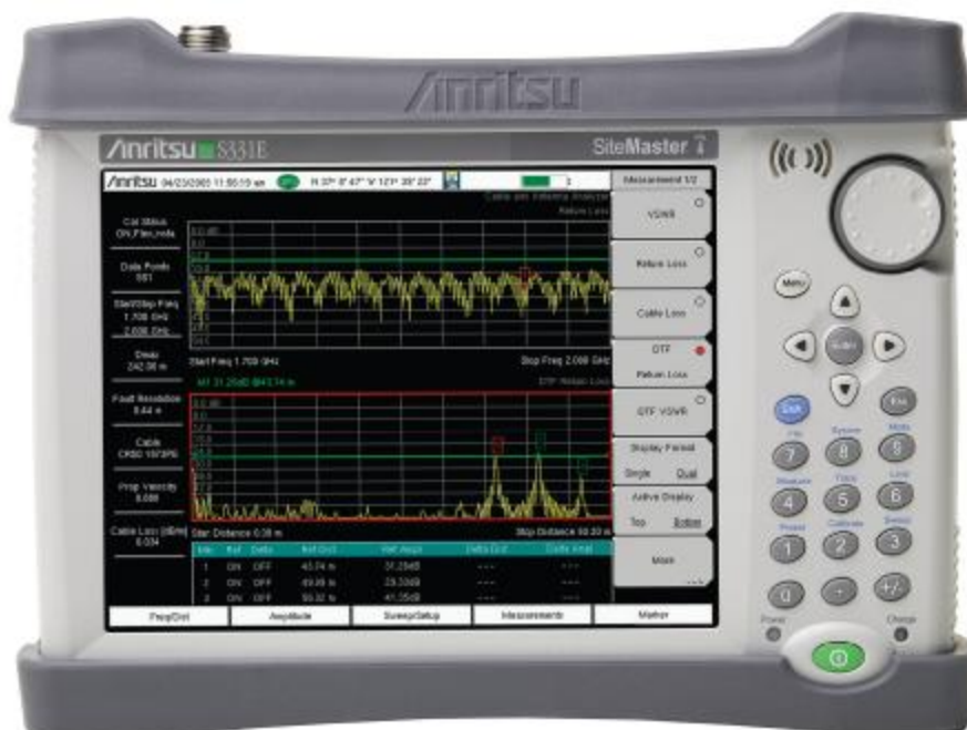
Site Master™S331E 天馈线分析仪具有 8.4"日光下可清晰显示的触摸屏 体积小: 273 x 199 x 91 mm (10.7 x 7.8 x 3.6 英寸), 重量: 2.71 kg (6.0 lbs)
